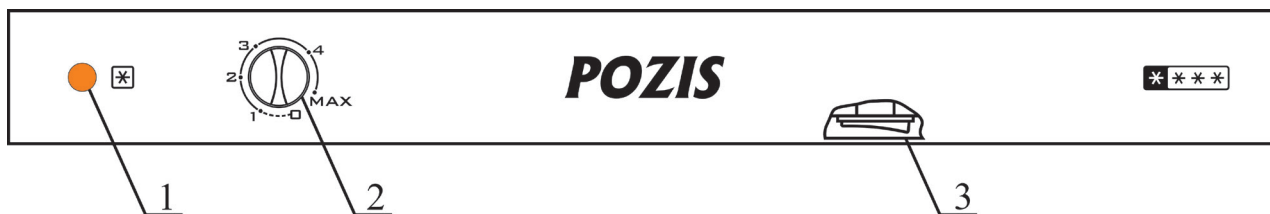
Рис.2 Схема расположения приборов управления и сигнализации 1 – индикаторная лампа; 2 – ручка терморегулятора; 3 – переключатель;
