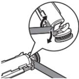
**8** Вставьте отвертку в щель между нижней частью аккумулятора и черной рамкой, чтобы снять металлический фиксатор, соединяющий аккумулятор с печатной платой зеленого цвета. Нижняя часть аккумулятора будет извлечена из рамки.
