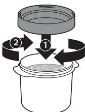
**8** Прикрепите отделение для крекеров и зафиксируйте его, повернув по часовой стрелке.
