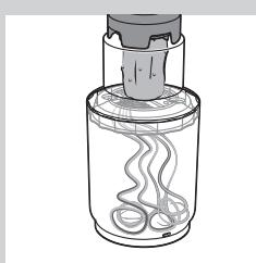
11 После завершения резки отпустите переключатель, чтобы выключить прибор, а затем отсоедините его от сети.
