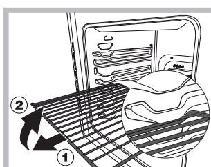
**ВНИМАНИЕ** Духовой шкаф укомплектован системой блокировки решеток, позволяющей вынимать их из духовки не полностью (1). Для полного вынимания решеток достаточно поднять их, как показано на схеме, взяв их за передний край, и потянуть на себя (2).
