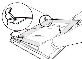
**4.** Зафиксируйте верхний край: Щелчок означает правильную установку. Перед установкой дверцы проверьте целостность уплотнения.
