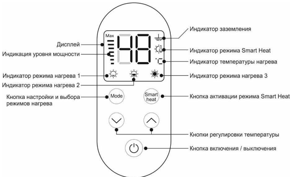
Рис.7 Приборная панель ПЭВН
