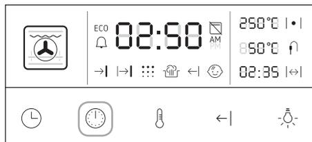
Функция часов: ТАЙМЕР, ПРОДОЛЖИТЕЛЬНОСТЬ РАБОТЫ, ФУНКЦИЯ ЗАДЕРЖКИ СТАРТА - включаются нажатием на сенсор, обозначенный символом 🕒. Чтобы воспользоваться одной из вышеперечисленных функций, необходимо нажать на сенсор (звуковой сигнал [подтверждение]) до момента, символ выбранной функции должен начать мигать. Затем воспользоваться **регулятором изменения настроек** для установки времени.
