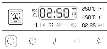
После подключения прибора к электросети раздается звуковой сигнал [подтверждение], необходимо установить текущее время. Отсутствие текущего времени не позволит духовке работать. Духовка не реагирует на входные сигналы регуляторов и неактивных сенсорных кнопок - генерируется звуковой сигнал [ошибка].
