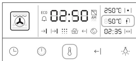
После подключения датчика температуры в каждой позиции **регулятора выбора функции**, кроме **ОЧИСТКИ** и позиции **0**, на дисплее в месте представленном ниже подсвечиваются символы  $\uparrow$  и заданная температура термозонда, по умолчанию 80°C.
