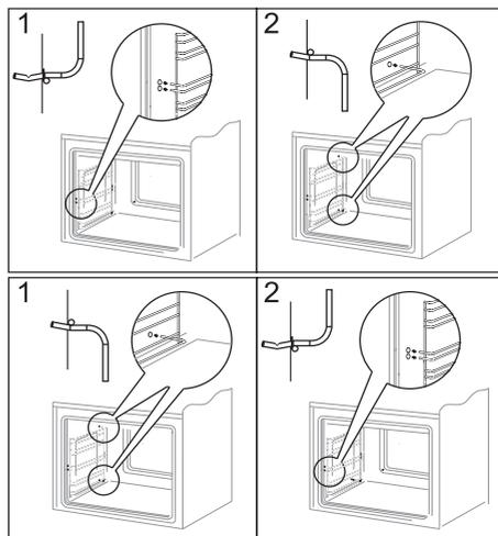
Духовки, обозначенные буквами **Dr**, оборудованы в нержавеющие телескопические (раздвижные) направляющие, прикреплённые к проводочным проводникам. Направляющие следует вынимать и мыть вместе с проводочными проводниками. Перед размещением на них противеней, следует их выдвинуть (если духовка нагрета, проводники надо выдвинуть, зацепив задним краем противеня за буфера, которые находятся в передней части проводников) и затем ввести вместе в противенем.
