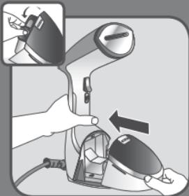
**BG** Върнете резервоара за вода на мястото му в уреда. Уверете се, че резервоарът за вода е поставен добре на мястото си.
