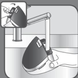
**BG** Отстранете стопера на входа за вода и напълните резервоара за вода с чиста вода от чешмата.
