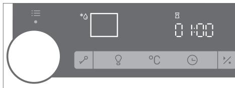
Установите переключатель РЕЖИМА НАГРЕВА в положение «Размораживание».
