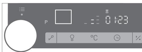
**3** Через некоторое время после начала пиролитической очистки для обеспечения безопасности дверца духовки автоматически заблокируется. На дисплее загорится символ «Ключ».
