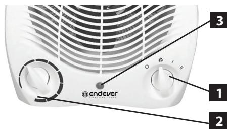
Когда температура помещения достигнет желаемого уровня, поверните ручку термостата (2) против часовой стрелки до тех пор, пока прибор не выключится (индикатор работы (3) выключится). После этого температура в помещении будет поддерживаться автоматически, периодически включая и выключая вентилятор.
