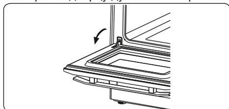
2. Откройте опорный подвес (a) (с помощью отвертки) до конца.
