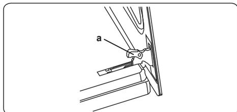
3. Закройте дверцу почти до упора и снимите ее, потянув на себя.
