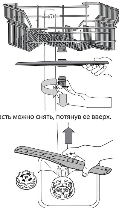
Нижнюю лопасть можно снять, потянув ее вверх.
