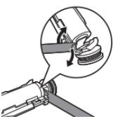
**8 Вставьте отвертку в щель между нижней частью аккумулятора и черной рамкой, чтобы снять металлический фиксатор, соединяющий аккумулятор с печатной платой зеленого цвета. Нижняя часть аккумулятора будет извлечена из рамки.**
