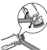
**8** Батареяны жасып басып шығарылған схемалы тақтаға жалғап түрған метал ілмекті сындыру үшін бұрауышты батареяның төменгі жағы мен қара жақтау арасына салыңыз. Бұл батареяның төменгі жағын жақтаудан ажыратады.
