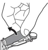
**9 Потяните аккумулятор из отсека для внутренних элементов, чтобы отсоединить второй металлический фиксатор аккумулятора.**
