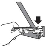
**7 Вставьте отвертку в щель между аккумулятором и черной рамкой в нижней части блока внутренних элементов. Затем поденьте аккумулятор с помощью отвертки, чтобы отсоединить нижнюю часть черной рамки.**
