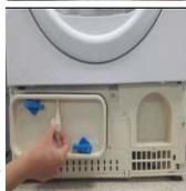
3.Вытащите блок с конденсатором.
