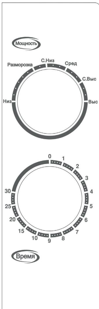
Панель состоит из двух ручек управления. Одна из них является ручкой управления таймером, а другая – для мощности.
