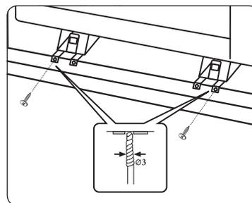
4. Просверлите отверстия с помощью сверла диаметром 3 мм. Закрепите винты в **Кронштейн основания**.
