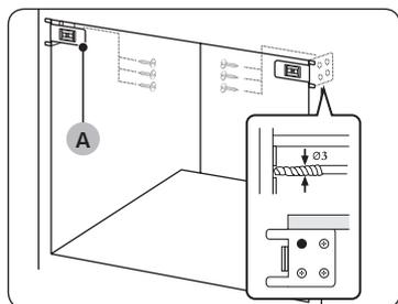
1. Просверлите отверстия с помощью сверла диаметром 3 мм. Закрепите винты в **Установочный кронштейн (A)**.
