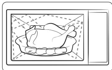
1. Микроволны, генерируемые магнетроном, отражаются стенками внутренней камеры микроволновой печи и равномерно распределяются в пище, когда она вращается на подносе. За счет этого пища готовится равномерно.
