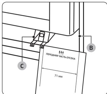
3. При помощи шаблона расположите **Кронштейн основания (C)** на расстоянии 71 мм от стороны "B" отсека.
