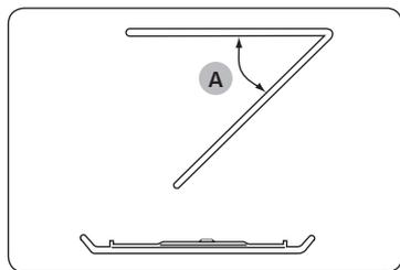
Чтобы очистить верхнюю часть камеры приготовления, опустите верхний нагревательный элемент на 45° (A), как показано на рисунке. Это позволит получить доступ к верхней части. Закончив работу, поднимите верхний нагревательный элемент в исходное положение.
