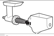
Наденьте корпус протирки на конус и зафиксируйте на верхней части кольца.
