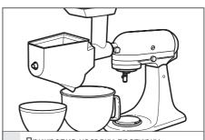
Прикрепив насадку-протирку к настольному миксеру, подставьте чашу миксера под корпус протирки, чтобы в ней собирались протертые продукты, а также подставьте чашу меньшего размера под открытый конец корпуса протирки, чтобы в не попадали пишевые отходы.
