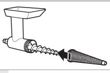
Наденьте протирочный конус на открытый конец большого шнека, 3 совместив выступы на конусе с прорезями в корпусе мясорубки.
