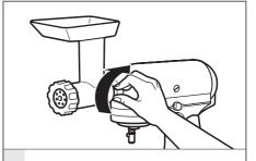
Затяните крепежный винт 4 привода миксера, пока насадка не будет надежно закреплена.
