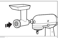
Подсоедините насадку к приводу миксера, убедившись, что вал насадки совмещен с квадратным гнездом привода миксера. При необходимости вращайте
