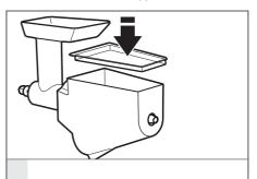
Наденьте крышку на корпус протирки.
