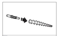
Вставьте до упора меньший конец вала с пружиной в отверстие 1 большого шнека.
