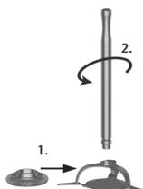
При повторной сборке ДИСК для обработки молока (10) необходимо вставить в скобу ДИСКА (9) бороздкой вверх. Затем следует полностью закрутить ручку (8) в скобу ДИСКА (9), прилагая усилие сверху. Теперь ДИСК для обработки молока (10) гибко закреплен на скобе.
