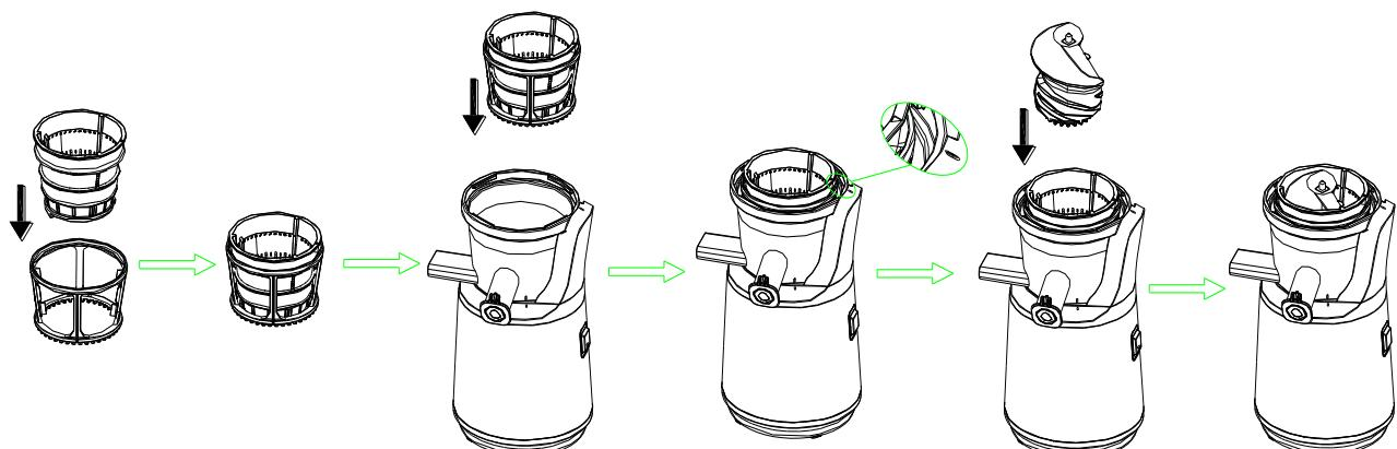
3. Установите крышку с загрузочным лотком поверх чаши. При установке совместите насечку на крышке (рядом символ ) с насечкой на моторном блоке. Затем поверните крышку по часовой стрелке, пока насечка на крышке (рядом символ ) не совпадет с насечкой на моторном блоке. Устройство не
