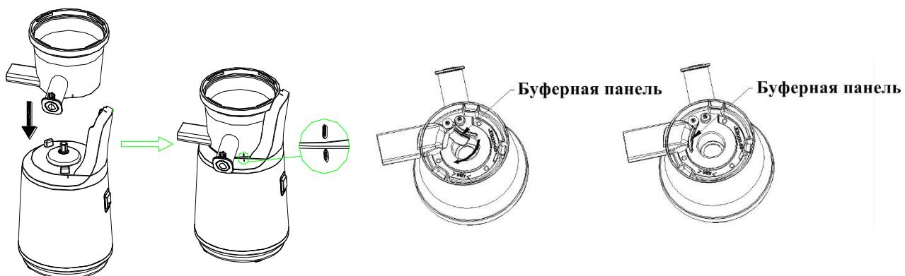
2. Установите фильтр в держатель для фильтра. Затем поместите фильтр с держателем в чашу, совместив насечки на фильтре и моторном блоке. После этого установите шнек в фильтр. Убедитесь, что шнек правильно и надежно установлен.
