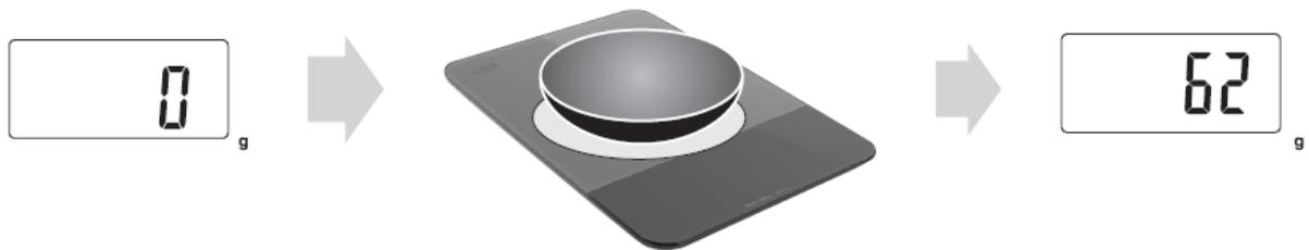
2. Нажмите клавишу TARE, вес емкости будет сброшен, на дисплее отобразится «0».
