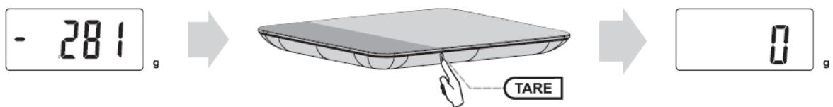
6. По окончании работы с весами нажмите клавишу TARE, чтобы отключить весы. Если весы не будут использоваться в течение 60 секунд, они автоматически отключатся.
