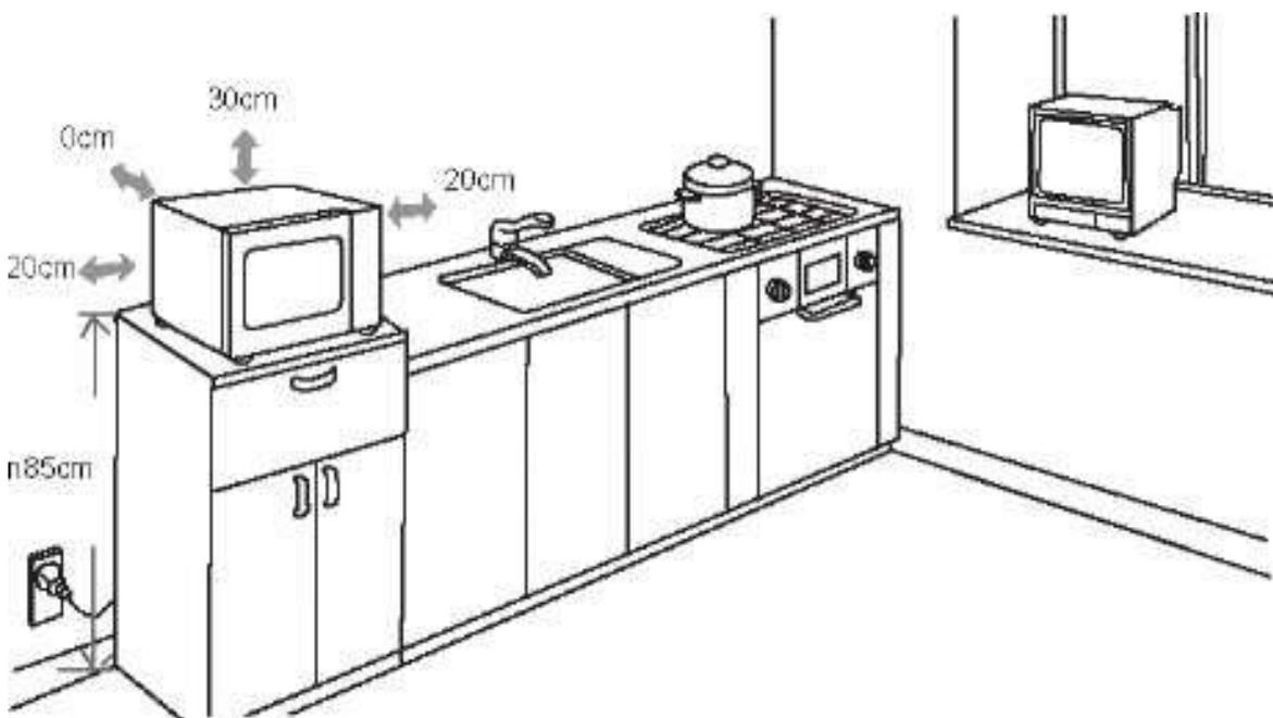
Задняя панель корпуса печи должна быть на расстоянии от стенки не менее 30см, а боковые панели корпуса печи должны быть на расстоянии не менее 20см от стенок.
