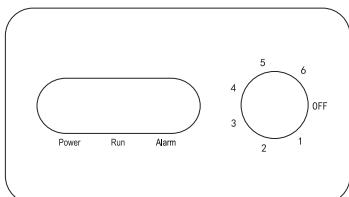
Подключите прибор к источнику питания, индикатор «Power» загорится. При включении компрессора, загорается индикатор «Run». Индикатор «ALARM» загорается, когда внутренняя температура в приборе слишком высокая.
