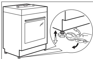
Для выравнивания по высоте верхней части прибора с другими поверхностями используйте маленькие ножки в нижней части прибора.
