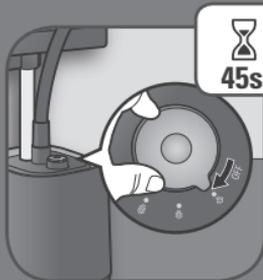
**RU** Поверните переключатель, чтобы включить устройство. Затем выберите с помощью переключателя мощность паровой струи.
