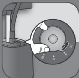
**CZ** Zařízení vypnete otočením hlavního vypínače do polohy „OFF“ (VYP).
