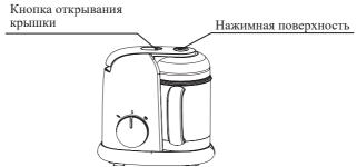
Для установки чаши поместите ее на моторный блок ручкой к себе, затем поверните чашу по часовой стрелке до упора для фиксации. Если чаша установлена неправильно, блендер не включится.
