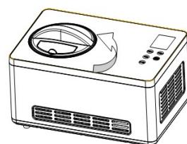
**Шаг 4.** Установите мешалки в съемную чашу. При этом отверстие в дне должно соответствовать оси мотора. Затем установите на устройство прозрачную крышку и зафиксируйте её в направлении против часовой стрелки.
