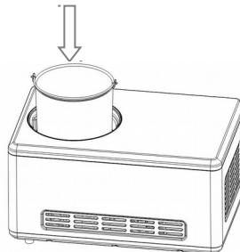
**Шаг 3.** Установите съемную чашу в устройство и слегка нажав, поверните её до плотной посадки в фиксированной чаше.
