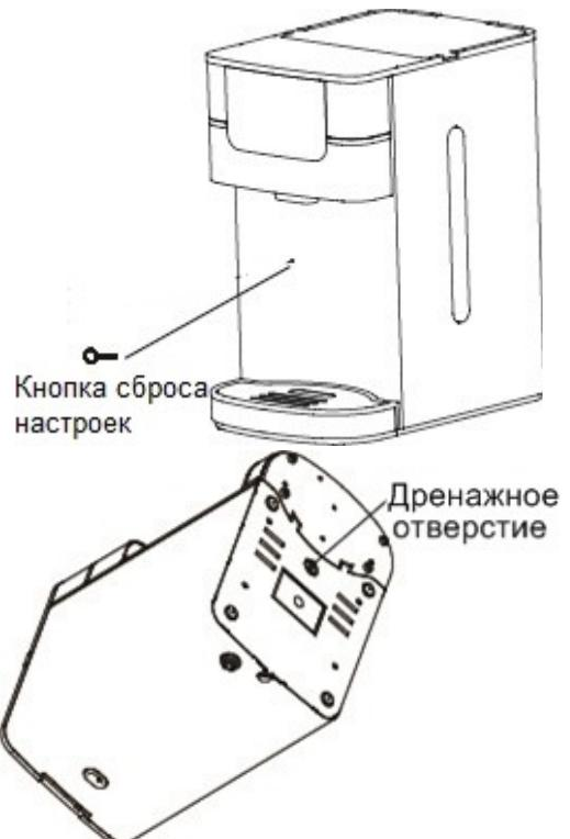
После очистки устройства откройте дренажное отверстие, чтобы слить отработанную воду. По окончании слива закройте дренажное отверстие.
