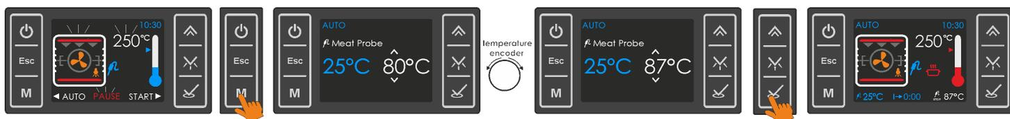
Примечание: В нижней строке экрана будет отображаться текущая температура термометра для мяса, истекшее время приготовления и заданная температура термометра для мяса.
