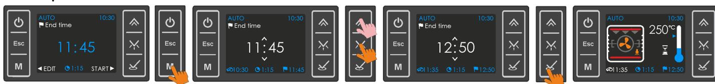
Примечание: В нижней строке экрана будет отображаться время начала готовки, время приготовления и время завершения приготовления.
