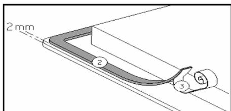
Приклейте уплотнение на расстоянии два (2) миллиметра от внешнего торца стеклокерамики, удалив защитный слой (3).
