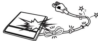
**!** Для подключения используйте розетку с заземлением, рассчитанную на ток 10-16А. Не включайте в одну розетку с индукционной плиткой приборы с высоким уровнем потребления, такие как кондиционеры и электрические печи. Не используйте удлинители.
