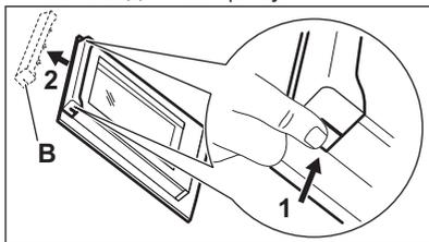
9. Чтобы снять дверную планку, потяните ее вперед.
