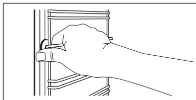
2. Вытяните заднюю часть направляющей из боковой стенки и снимите ее.
