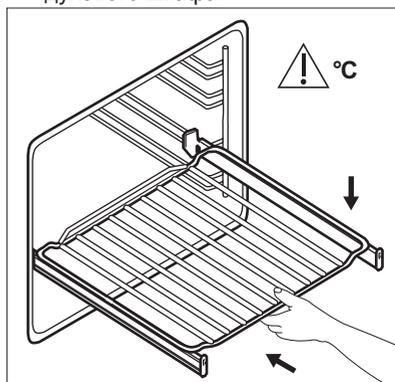
Обязательно полностью задвиньте телескопические направляющие внутрь духового шкафа перед тем, как закрыть дверцу духового шкафа.
