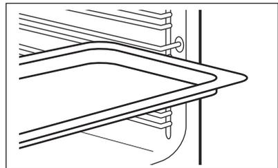
Одновременная установка решетки и эмалированного противня / сотейника:
