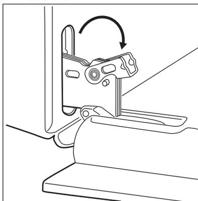
6. Прикройте дверцу наполовину до первого фиксируемого положения. Затем вытяните дверцу вперед из ее гнезда.
