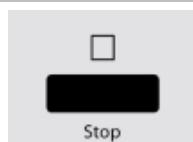
Нажмайте кнопку **Stop (Стоп)** в течение трех секунд, пока не услышите долгий звуковой сигнал и не загорится индикатор функции „lock“. В заблокированном состоянии все кнопки дезактивированы.
