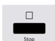
Нажмайте кнопку **Stop (Стоп)** в течение трех секунд, пока не услышите долгий звуковой сигнал и не погаснет индикатор функции. В разблокированном состоянии все кнопки вновь активированы.
