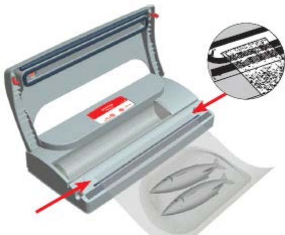
Рисунок 4: Поместите наполненный пакет в центр вакуумного отделения (между рельефной кольцевой линией - см. стрелки).
