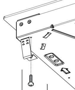
Центрируйте и вставьте варочную панель. Нажмите по сторонам варочной панели, пока она не станет на опору по всему периметру.
