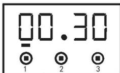
3. Через 5 секунд после установки таймера или прямого нажатия кнопки 2 загорится сигнальная функция ☺. Новые данные сохранены.
