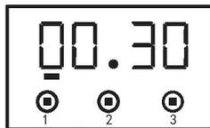
5. Нажмите любую кнопку, сигнальная функция и звуковой сигнал выключатся. Звуковой сигнал будет выключен автоматически через 2 минуты.
