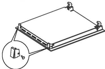
Снятие внутренней стеклянной панели
