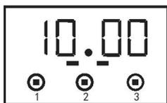
3. Через 5 секунд после установки включится автоматическая функция.
