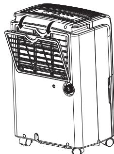
8. Для непрерывного отвода конденсата используйте шланг вместе с адаптером, который идет в комплекте. Откройте отверстие для непрерывного отвода конденсата, повернув заглушку против часовой стрелки. Вставьте адаптер и подсоедините дренажный шланг. Шланг должен быть проложен ровно, без изгибов. Обеспечьте сток конденсата.
