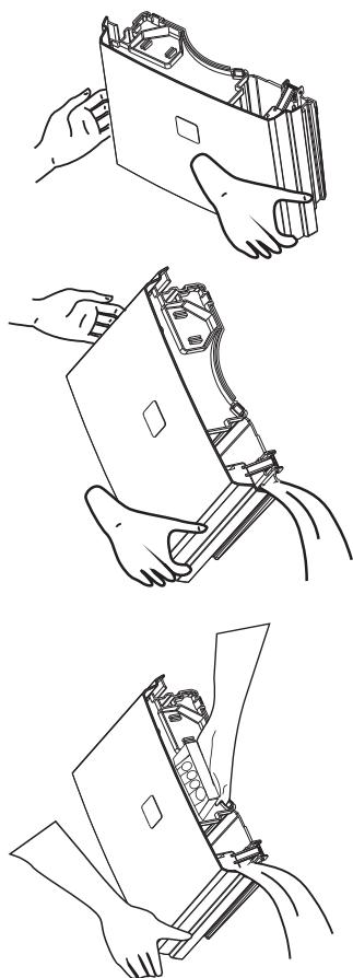
7. Чистка фильтра. Когда необходимо почистить фильтр, загорается индикатор Чистка фильтра (примерно после 250 часов работы). Достаньте фильтр, как показано на рисунке ниже, промойте его в мыльной воде, прополощите в чистой воде, высушите и вставьте на место. Нажмите кнопку Чистка фильтра чтобы перезапустить индикатор.
