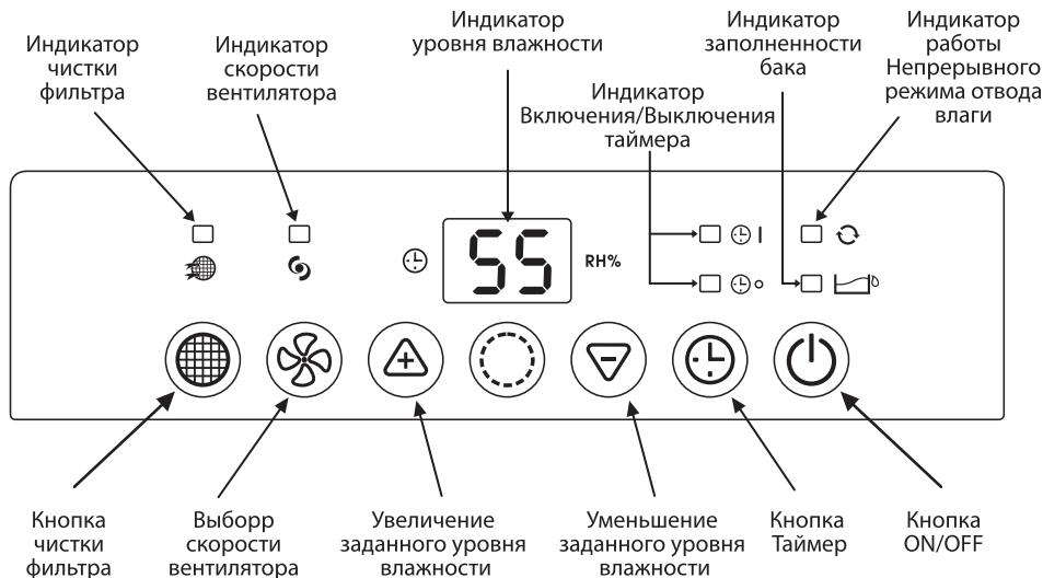
1. В первый раз используя осушитель, включите его минимум на 24 часа в Непрерывном режиме.
