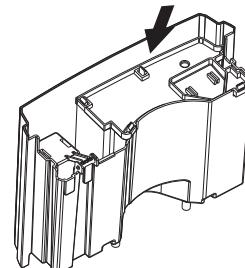
Наклоните прибор не ниже чем на 45 градусов и с небольшим усилием вставьте пластиковые шасси в специальные пазы.
