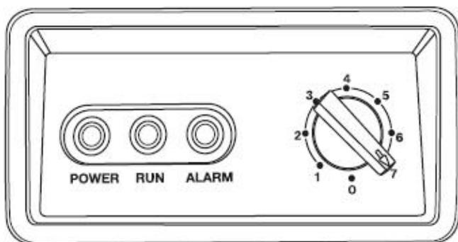
**Индикатор POWER (мощность):** зеленый индикатор загорается, когда камера подключается к электрической розетке.
