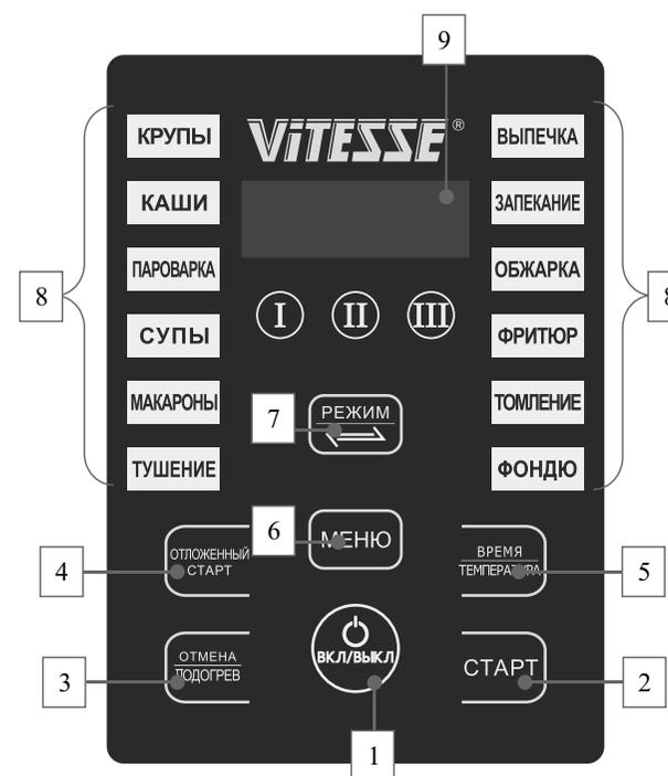
1. Кнопка «ВКЛ/ВЫКЛ» (для включения и выключения прибора)
