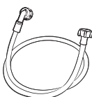
Шланг подачі гарячої води
