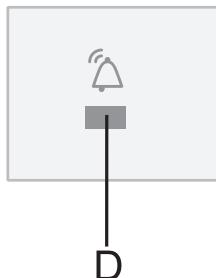
При превышении допустимой температуры в приборе включается прерывистый звуковой сигнал и мигает лампочка **D**.
