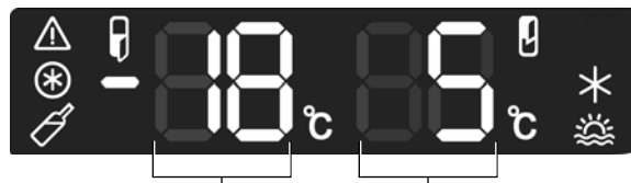
ТБ дөгү температура МБ дөгү температура
