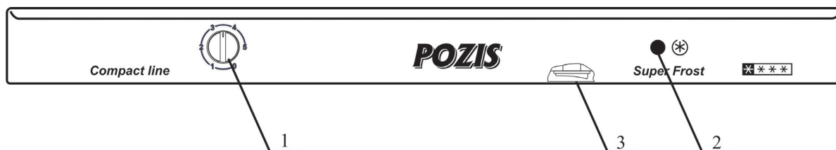
Рис.2 Схема расположения приборов управления и сигнализации 1 – ручка терморегулятора; 2 – индикаторная лампа; 3 – переключатель;
