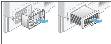
6. Промойте теплообменник со всех сторон под струёй воды, чтобы полностью удалить все ворсинки.
