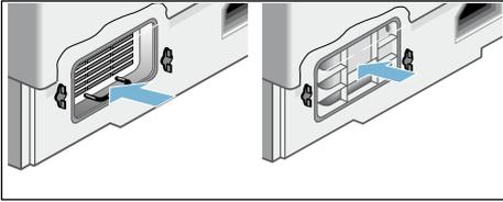
10. Поверните оба рычага фиксатора в горизонтальное положение так, чтобы приставка не смогла отсоединиться.
