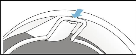
Корзина для сушки шерсти зафиксирована в барабане сушильной машины.
