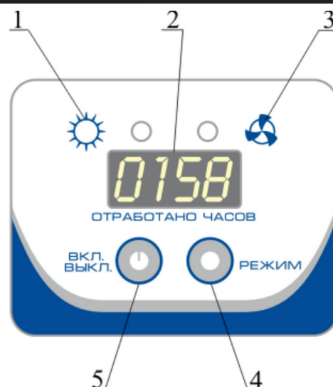
Рис.1 Схема расположения органов управления и индикации
