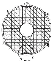
2. Опустите зажимы так, чтобы надежно скрепить решетки вместе. В винтовые отверстия закрутите гайки.
