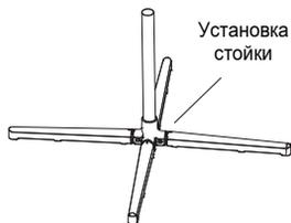
Закрутите винт крепления стойки в основании подставки
