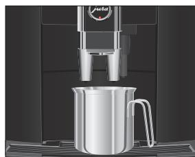
▶ Поставьте по одной емкости под насадку для подачи горячей воды и под дозатор кофе.
