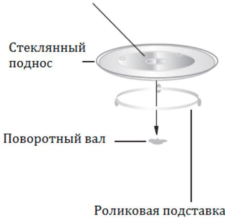
На поворотную ось устанавливается стеклянный поднос. Под стеклянный поднос устанавливается роликовая подставка, которая помогает подносу свободно вращаться. Вращение пищи во время работы печи способствует ее равномерному приготовлению.
