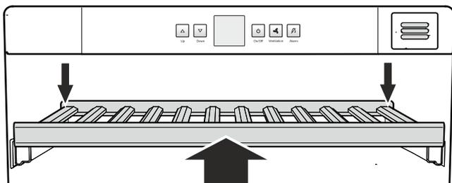
Придавите деревянную полку до конца назад, чтобы она спереди вошла в зацепление.
