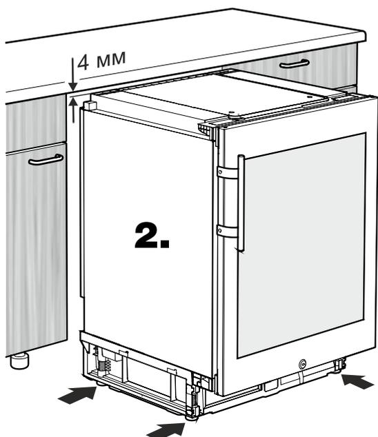
2. Отрегулируйте прибор по высоте поворотом ножек по часовой стрелке, не доходя на 4 мм до высоты ниши.
