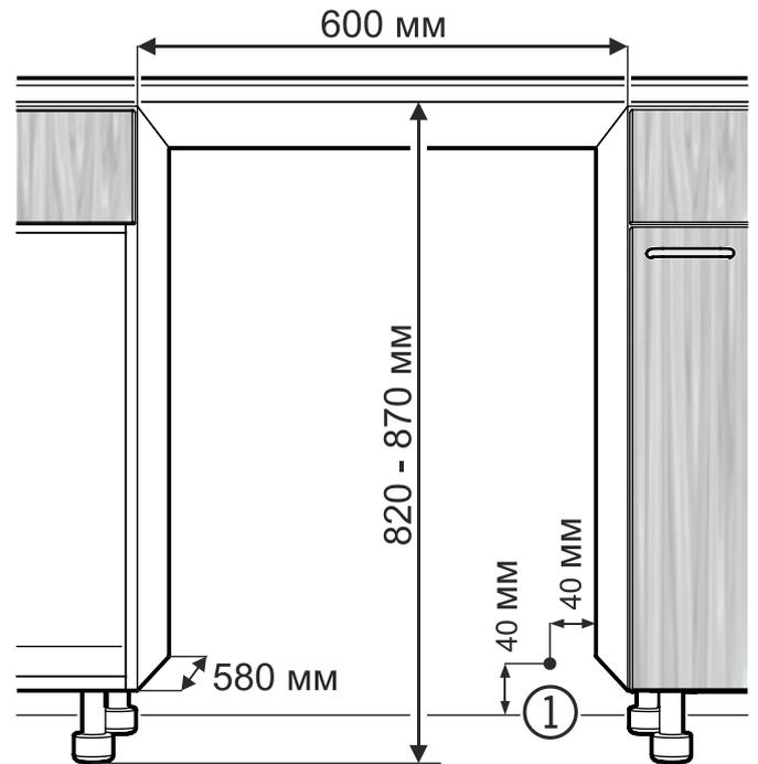
① В этом месте с тыльной стороны прибора прокладывается провод подключения к сети.
