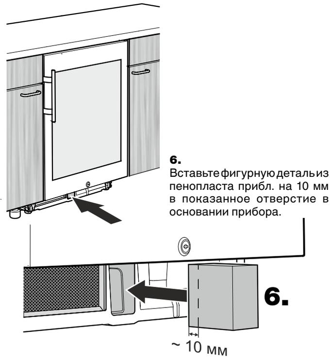
**6.** Вставьте фигурную деталь из пенопласта приibl. на 10 мм в показанное отверстие в основании прибора.
