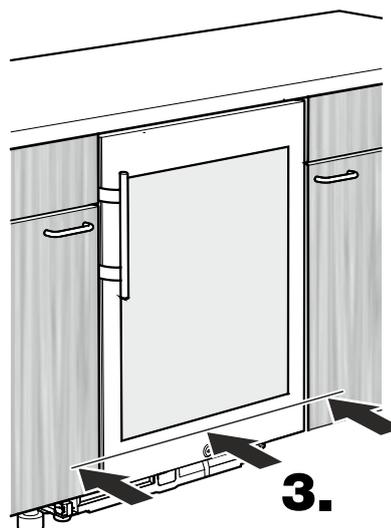
3. Задвиньте прибор, чтобы передняя поверхность двери прибора была заподлицо с передними панелями мебели.
