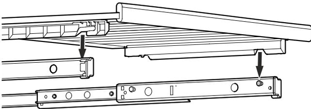
Вытяните до предела полость секции. Положите деревянную полку передними пазами на упорные штифты.
