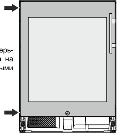
23. Закройте дверь и проверьте, находится ли она на одной линии с боковыми стенками прибора.
