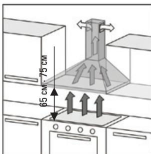
В режиме рециркуляции (Рис. 5) вытяжка не подключается к вентиляционной шахте. Воздух просто прогоняется через вытяжку внутри кухни. В этом режиме на вытяжку должны быть установлены сменные угольные акриловые запахоулавливающие фильтры. Эти фильтры не входят в комплект вытяжки и приобретаются отдельно. Использование вытяжки в режиме рециркуляции снижает ее производительность.
