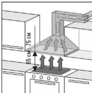
Кухонная вытяжка предназначена для удаления запахов с кухни, в зависимости от ее установки, может работать в двух режимах:
