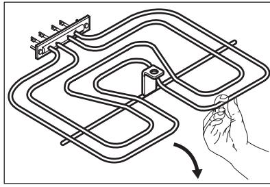
3. Протрите потолок духового шкафа мягкой тканью, смоченной теплой водой с мыльным средством, и дайте ему высохнуть. Верните нагревательный элемент на место, действуя в обратной последовательности.
