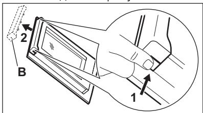
3. Чтобы снять дверную планку, потяните ее вперед.
